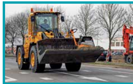
Een wielladerbak is een verwisselbare uitrustingsstuk. Bij meer dan 10 cm uitsteken (buiten de banden) moet de bak worden gemarkeerd.
