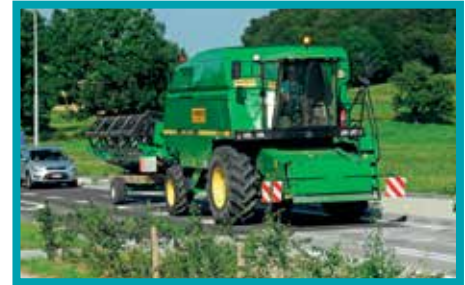
Deze maaidorser kan niet harder dan 30 km/h en moet een bedrijfsrem hebben met een remvertraging van ten minste 2,4 \text{ m/s}^2 .
