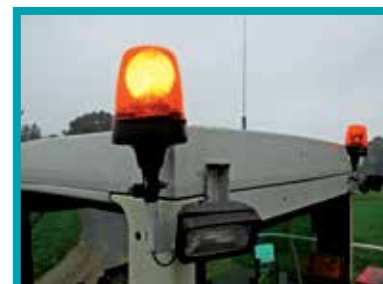
Elk voertuig breder dan 2,60 meter moet een zwaai- of knipperlicht kunnen voeren.
