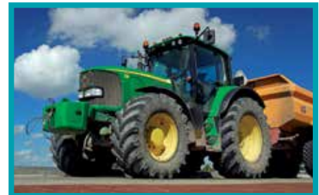
De remvertraging van deze trekker moet minimaal 3,1 \text{ m/s}^2 bedragen.
